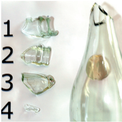
Abb. 2: gebrochene Schaumweinflasche – Hauptbruchstücke
